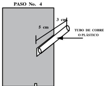
Vuelva a soplear con aire a presión por medio de los tubos, para retirar el polvo interior y aplique sobre la fisura un cordón de **UNECRETO EPOXI PASTA** (adhesivo epóxico en pasta), una vez endurecido el adhesivo proceda al siguiente paso:
