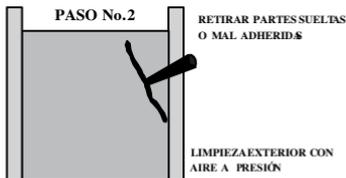
En grietas o fisuras verticales, soplear con aire a presión para retirar partes flojas o sueltas. Sobre la grieta o fisura haga una perforación a cada 15 o 20 cm con una profundidad de 3 a 5 cm con un diámetro de 1/4" o 3/8" y con una inclinación de 15 positivos. Inserte tubos de cobre o de plástico en las perforaciones anteriores, quedando sobresalidos unos 3 cm.
